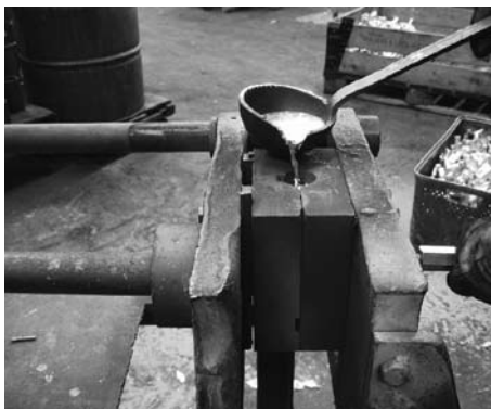
Coquillemal, Melisgieterijen, Tilburg
